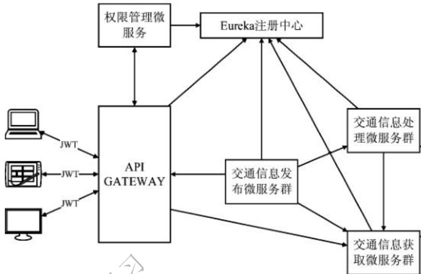
在逻辑上，交通信息平台后端分为信息采集，信息处理，信息发布三个模块，每个模块按处理数据的不同，又包含多个微服务，因此我们将系统分为交通数据采集、交通部门信号采集、路况数据处理、车位数据处理、路况数据发布、车位数据发布以及权限管理共 7 个微服务，同时将项目团队划分为 3 个小组。根据功能的轻重缓急和工作量，安排各个微服务的研发。每个小组负责一个或多个组件完整的生命周期，即服务谁开发，服务谁运营。最后各个服务组件通过 RESTful HTTP 协议和消息路由功能进行服务组装。
