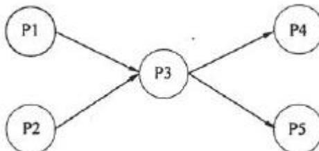
若用 PV 操作控制进程并发执行的过程，则需要设置 4 个信号量 S1、S2、S3 和 S4，
