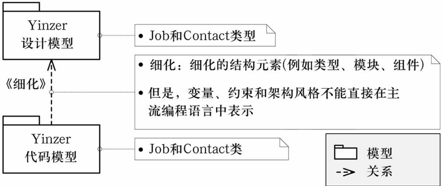
图7.3 细化关系，确保领域中选择类型与设计模型中的类型或数据结构相对应。需要明确，设计模型中的一些元素(变量、约束、风格)无法直接展现在编程语言中
