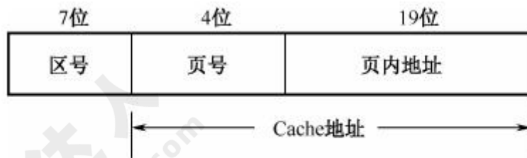
图 1-3 直接映像方式的主存地址
