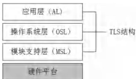
图 3.1 宇航嵌入式设备软件架构
