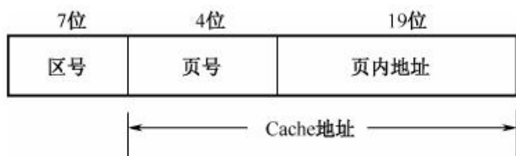
图 1-3 直接映像方式的主存地址
