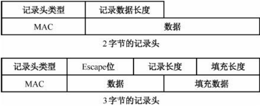
图 16-10 SSL 协议记录头格式
