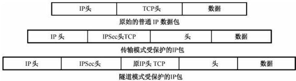
图 16-8 不同传输模式下的 IP 包
