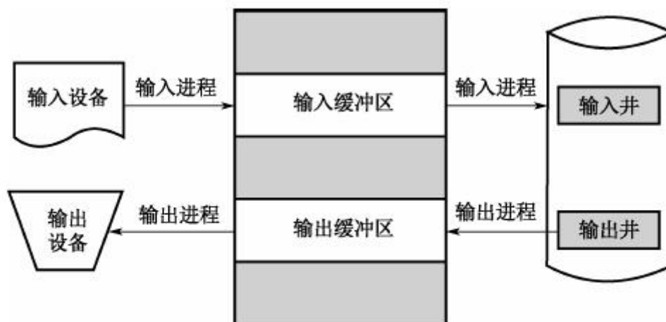
图 2-8 SPOOLING 系统示意图
