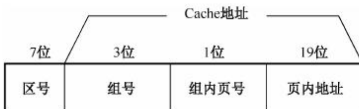
图 1-8 组相联映像方式的主存地址
