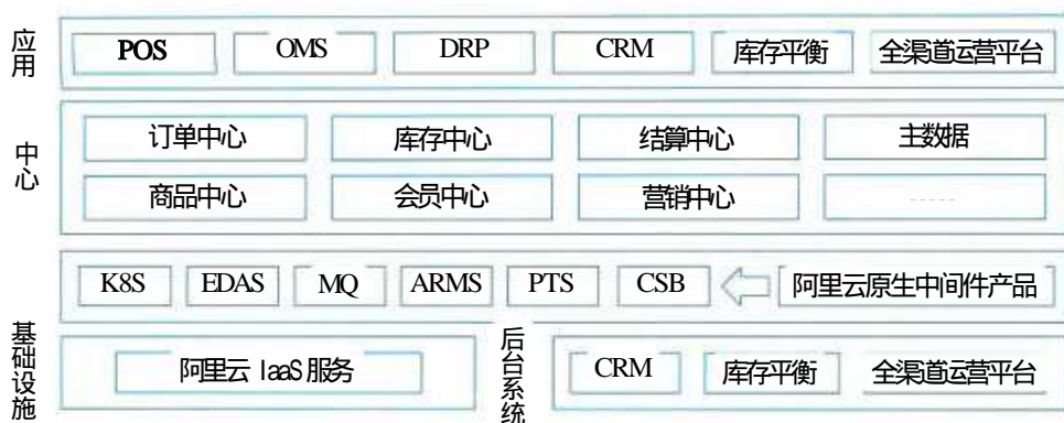
图14-10基于云原生中间件的技术架构示意图
