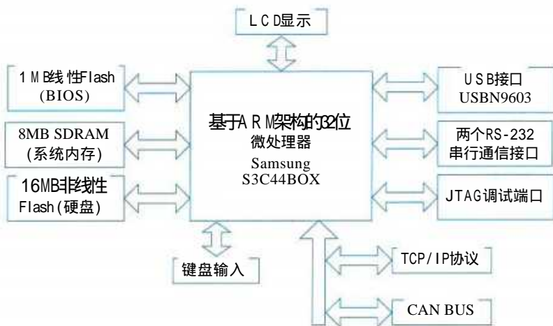
图2-11 基于A R M处理器的嵌入式计算机硬件组成
