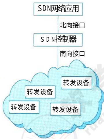
图 17-17 SDN 网络架构
