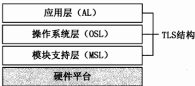
图 12-7 宇航嵌入式设备软件架构
